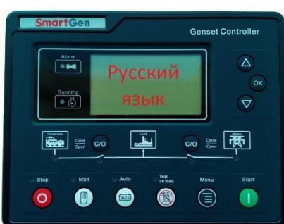
Стандартно на генераторную установку устанавливается контроллер «Smartgen», который представляет собой комплексное устройство с функцией AMF, как для одиночных ДГУ в режиме ожидания, так и для ДГУ в режиме двойного резервирования. Все программируемые параметры, могут быть изменены с передней панели в режиме эксплуатации. В журнал событий включается не только дата, время, информацию, но и полный перечень измеряемых параметров генератора на момент возникновения неисправности.
